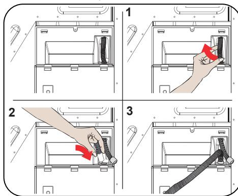
**! УВАГА:** Шланг необхідно під'єднувати так, щоб він не зміг від'єднатися. Якщо шланг від'єднається під час зливу води, можливе затоплення приміщення.
